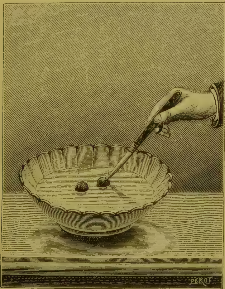
Fig. 30. Esperimento sull'attrazione molecolare.
